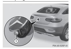
La caméra de recul ① est un système optique d'aide aux manœuvres. Elle vous permet de voir sur le visuel du système Audio 20/de COMAND Online la zone qui se trouve derrière le véhicule, représentée par des lignes repères.
