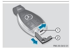
▶ Déplacez le poussoir de déverrouillage ① dans le sens de la flèche, maintenez-le dans cette position et retirez la clé de secours ② de la clé.
