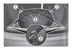
Sur les véhicules équipés du système de sonorisation Bang & Olufsen, la roue de secours compacte « Minispare », ou roue de secours compacte « à pneu pliable » sur la Mercedes-AMG GLE 63, est rangée dans sa housse. La housse de la roue de secours est fixée aux anneaux d'arrimage qui se trouvent dans le compartiment de chargement.
