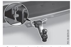
► Contrôlez que la rotule, le goujon et la goupille à ressort sont correctement montés.
