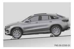
Sur une descente douce: placez une cale ou un autre objet approprié sous chacune des roues avant et arrière.
