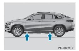
Les points d'appui du cric se trouvent derrière les passages des roues avant et devant les passages des roues arrière (flèches).
