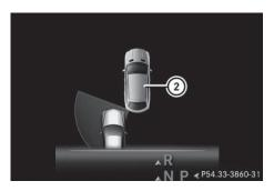
Lorsqu'une intervention de freinage permettant de corriger la trajectoire a lieu, le voyant rouge d'alerte ① intégré au rétroviseur extérieur clignote et un double signal d'alerte retentit. En outre, un affichage ② signalant un risque de collision latérale apparaît sur le visuel multifonction.
