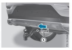
► Introduisez le goujon ⑤ dans l'alésage du support de rotule et dans celui de la rotule jusqu'en butée.
