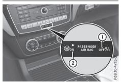
Les voyants PASSENGER AIR BAG OFF (1) et PASSENGER AIR BAG ON (2) font partie du système de classification des occupants (OCS).
