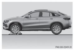
➤ Sur un sol horizontal: placez une cale ou un autre objet approprié devant et derrière la roue diagonalement opposée à la roue à remplacer.
