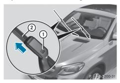
▶ Appuyez fermement sur le bouton de déverrouillage ① et dégagez le balai d'essuie-glace ② du bras en le tirant par le haut dans le sens de la flèche.
