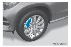
► A l'aide de la clé démonte-roue ①, dévissez les vis de la roue à changer de 1 tour environ. Ne les dévissez pas complètement.
