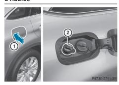
Lorsque vous ouvrez ou fermez le véhicule avec la clé ou avec la fonction KEYLESS-GO, la trappe du réservoir est automatiquement déverrouillée ou verrouillée.
