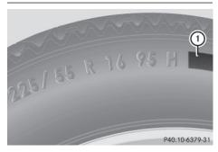
En plus de l'indice de charge, un code de charge ① peut être inscrit sur le flanc du pneu, après la lettre indiquant l'indice de vitesse ④ (> page 352).
