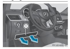
L'airbag de genoux côté conducteur ① se déploie en dessous de la colonne de direction. L'airbag de genoux côté conducteur se déclenche en même temps que les airbags frontaux.
