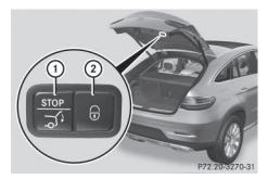
Touche de fermeture et touche de verrouillage (exemple: véhicule équipé de la fonction KEYLESS-GO) ► Fermeture: appuyez sur la touche de fermeture (1) qui se trouve dans le hayon.
