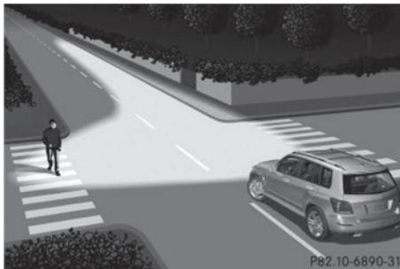
L'éclairage d'intersection augmente considérablement l'angle d'éclairage de la portion de route dans laquelle le véhicule s'engage et permet ainsi de mieux repérer les virages serrés, par exemple. L'éclairage d'intersection peut uniquement être activé lorsque les feux de croisement sont allumés.
