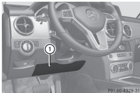
L'airbag de genoux côté conducteur ① augmente le potentiel de protection du conducteur contre
