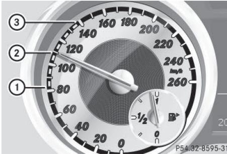
Lorsque vous activez le DISTRONIC PLUS, 1 ou 2 des segments ② du tachymètre correspondant à la vitesse mémorisée s'allument. Lorsque le DISTRONIC PLUS détecte un véhicule qui vous précède, les segments ② du tachymètre compris entre la vitesse de ce véhicule ① et la vitesse mémorisée ③ s'allument.
