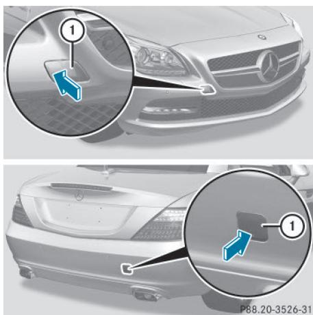
Les logements des anneaux de remorquage amovibles se trouvent dans les pare-chocs. Ils sont situés à l'avant et à l'arrière, sous les caches.
