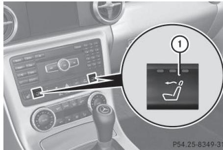
Le système AIRSCARF permet d'envoyer de l'air chaud au niveau de la tête et de la nuque des occupants du véhicule. L'air chaud sort par les buses situées au niveau des appuie-tête.
