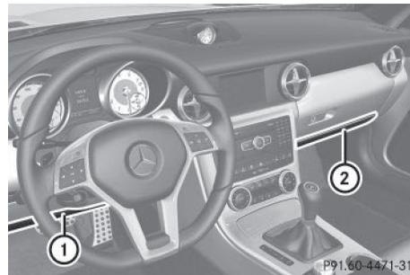
L'airbag de genoux du conducteur ① se déploie en dessous de la colonne de direction et l'airbag de genoux du passager ② en dessous de la boîte à gants. Les airbags de genoux côté conducteur et côté passager se déclenchent en même temps que les airbags frontaux.
