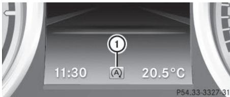
① Affichage de la fonction ECO de démarrage et d'arrêt automatiques du moteur
