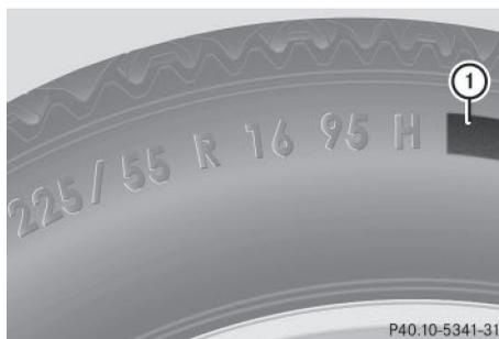
En plus de l'indice de charge, un code de charge
