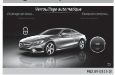
Lorsque le verrouillage automatique est activé, le véhicule se verrouille automatiquement dès lors que le contact est mis et que vous roulez à une vitesse supérieure au pas.
