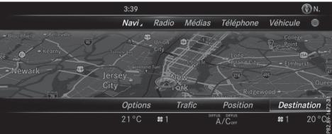
Le menu vous permet par exemple d'entrer une destination ou de sélectionner des réglages de navigation.
