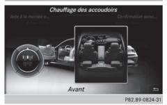
Le chauffage des accoudoirs permet de chauffer les surfaces avec lesquelles les occupants du véhicule entrent souvent en contact. L'activation du chauffage des accoudoirs par l'intermédiaire de COMAND Online, comme décrit ci-après, ne fonctionne que si le chauffage de siège est en marche (voir la notice d'utilisation du véhicule).
