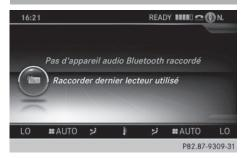
Pendant la recherche de téléphones portables, la liaison avec l'appareil audio Bluetooth® est interrompue (▷ page 149). Dans l'affichage de base Bluetooth® Audio (▷ page 245), vous voyez alors apparaître le message Pas d'appareil audio Bluetooth raccordé et le point de menu Raccorder dernier lecteur utilisé ne peut pas être sélectionné.
