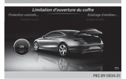
L'activation de la fonction Limitation d'ouverture du coffre permet d'éviter que le couvercle de coffre ne heurte le plafond du garage par exemple, si celui-ci est bas.
