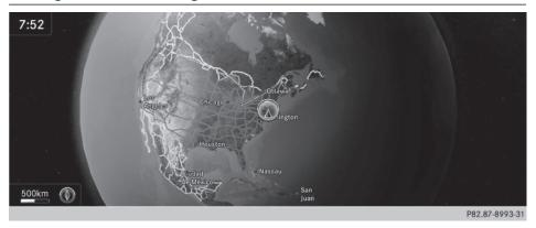
COMAND Online représente la carte de navigation et les images satellite projetées sur une sphère. Cela permet d'obtenir une représentation fidèle à la réalité, sans distorsion de forme, et ce, quelle que soit l'échelle.
