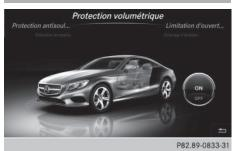
Si la protection volumétrique est activée et qu'un mouvement est détecté dans l'habitacle, une alarme optique et une alarme sonore se déclenchent. Cela peut être le cas, par exemple, lorsqu'une personne non autorisée pénètre dans l'habitacle.
