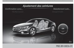
La fonction d'ajustement des ceintures de sécurité permet d'adapter les ceintures de sécurité au buste du conducteur et du passager.
