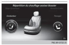
La balance régule la répartition de la puissance de chauffage au niveau du dossier et de l'assise.
