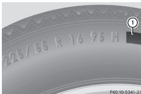
En plus de l'indice de charge, un code de charge ① peut être inscrit sur le flanc du pneu, après la lettre indiquant l'indice de vitesse (▷ page 290).
