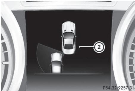
Lorsqu'une intervention de freinage permettant de corriger la trajectoire a lieu, le voyant rouge d'alerte ① intégré au rétroviseur extérieur clignote et un double signal d'alerte retentit. Un affichage ② apparaît en outre sur le visuel multifonction.
