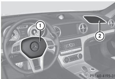
L'airbag frontal du conducteur ① se déploie devant le volant. L'airbag frontal du passager ② se déploie devant et au-dessus de la boîte à gants.
