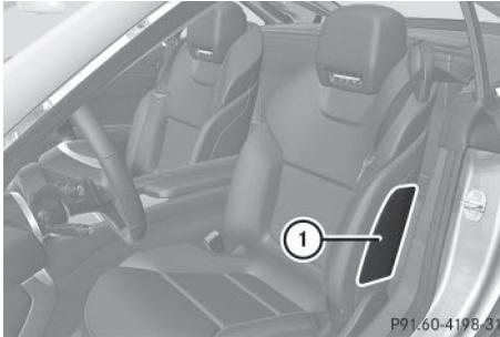
Les airbags latéraux ① se déploient au niveau des joues extérieures du dossier. Les airbags latéraux augmentent, en cas de déclenchement, le potentiel de protection au niveau de la cage thoracique. Ils ne protègent cependant pas
