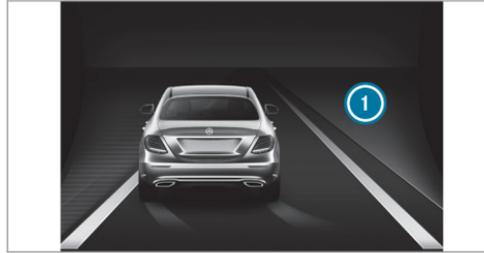
Lorsqu'une intervention de freinage permettant de revenir sur la voie empruntée a lieu, l'affichage ⓘ apparaît sur l'écran multifonction.
