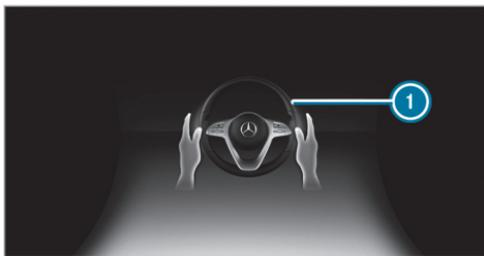
Si le système atteint une limite système, alors que le conducteur ne dirige pas lui-même le véhicule ou lâche le volant pendant une période prolongée, le système avertit le conducteur d'abord par un signal optique en fonction de la situation. L'affichage ① apparaît sur l'écran multifonction. Si le conducteur ne dirige toujours pas lui-même le véhicule ou que ses mains ne sont pas sur le volant, un signal d'alerte retentit de façon répétée en plus du message d'alerte optique.
