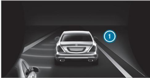
Lorsqu'une intervention de freinage permettant de corriger la trajectoire a lieu, le voyant rouge d'alerte intégré au rétroviseur extérieur clignote
