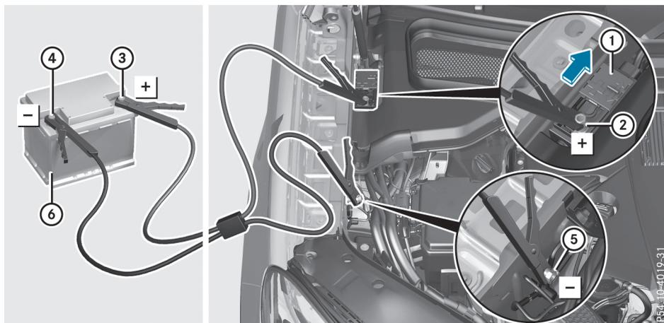
Le numéro ⑥ indique la batterie chargée de l'autre véhicule ou un dispositif d'aide au démarrage.
