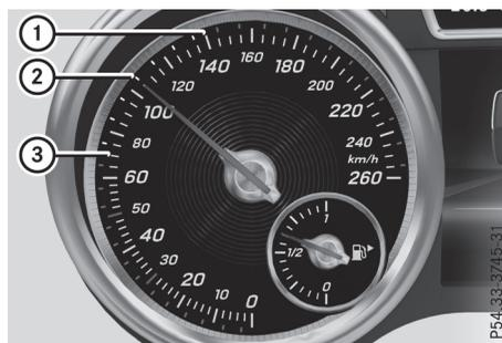
Affichage du pilote automatique de régulation de distance DISTRONIC sur le tachymètre (exemple)
