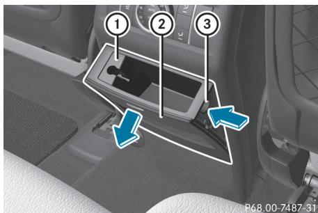
Les véhicules qui ne sont pas équipés du système multimédia arrière sont dotés d'un cendrier dans la console centrale arrière.
