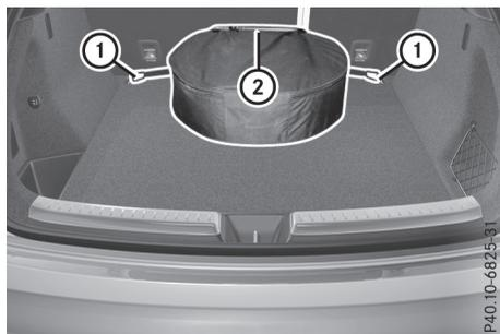
Extraction de la roue de secours compacte
