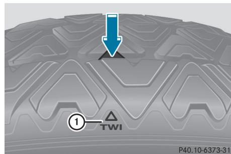
Le repère ① indique l'emplacement auquel l'indicateur (flèche) d'usure de la bande de roulement, qui se présente sous la forme d'une barrette, est intégré dans les sculptures du pneu. Les indicateurs d'usure de la bande de roulement sont prescrits par la loi. Les indicateurs
