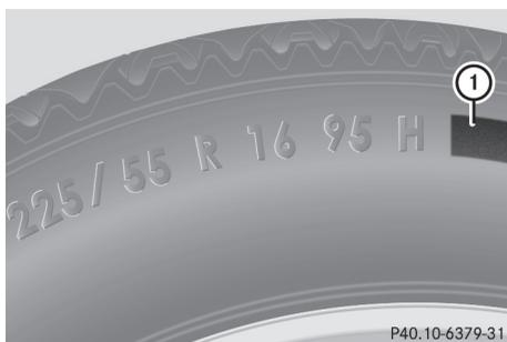
En plus de l'indice de charge, un code de charge ① peut être inscrit sur le flanc du pneu, après la lettre indiquant l'indice de vitesse ⑥ (▷ page 383).
