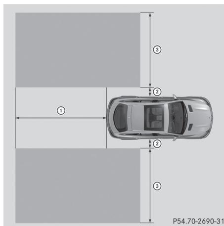
L'avertisseur actif d'angle mort surveille à une distance d'environ 1,6 ft (0,5 m) ② du véhicule la zone représentée sur l'illustration qui s'étend jusqu'à 10 ft (3 m) sur les côtés ③ et derrière ① votre véhicule.
