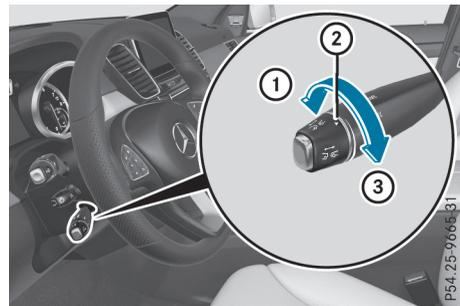
Vous pouvez régler la distance de consigne pour le pilote automatique de régulation de distance DISTRONIC en modulant le temps qui sépare votre véhicule de celui qui vous précède dans une plage allant de 1,0 à 2,0 secondes. Le pilote automatique de régulation de distance DISTRONIC se sert de cette indication pour réguler la distance par rapport au véhicule qui précède en fonction de la vitesse. Cette distance est affichée sur le visual multifonction (▷ page 185).
