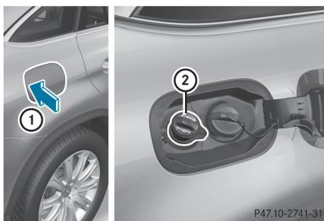
Lorsque vous ouvrez ou fermez le véhicule avec la clé ou avec la fonction KEYLESS-GO, la trappe du réservoir est automatiquement déverrouillée ou verrouillée.
