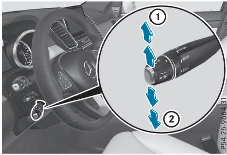
► **Augmentation ou diminution par paliers de 1 mph (Canada : 1 km/h)** : actionnez brièvement la manette du TEMPOMAT vers le haut ① pour augmenter la vitesse de consigne ou vers le bas ② pour la diminuer. La vitesse de consigne réglée apparaît sur le visuel multifonction avec le symbole DSR
