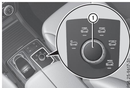
Dans le programme de conduite **Sport**, le réglage plus ferme de la suspension permet un contact avec la chaussée encore meilleur. Sélectionnez ce programme de conduite pour une conduite énergique, par exemple sur des routes de campagne sinueuses.
