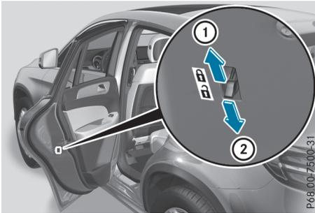
La sécurité enfants au niveau des portes arrière permet de condamner chaque porte séparément. Une porte condamnée ne peut pas être ouverte de l'intérieur. Vous pouvez ouvrir la porte de l'extérieur si le véhicule est déverrouillé.
