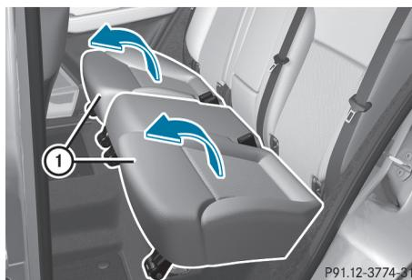
Si le siège du conducteur ou du passager a été réglé pour que des personnes de grande taille puissent y prendre place, il est possible que vous ne puissiez pas basculer la banquette arrière vers l'avant. Dans ce cas, avancez les sièges avant au maximum.
