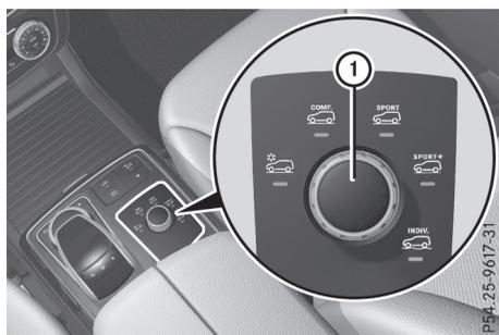
Dans le programme de conduite **Comfort**, la conduite de votre véhicule est plus confortable. Sélectionnez par conséquent ce programme de conduite si vous préférez une conduite confortable. Sélectionnez aussi le programme de conduite **Comfort** pour les lignes droites rapides, par exemple sur autoroute.
