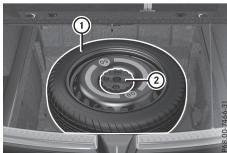
Extraction de la roue de secours compacte
