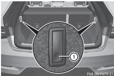
Un crochet pour sac est monté à droite et à gauche dans le compartiment de chargement.
