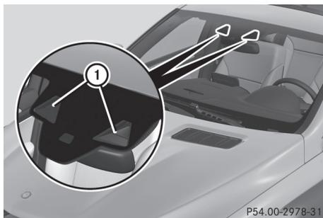
Le pilote automatique de régulation de distance DISTRONIC avec pilote automatique directionnel vous aide à conduire au milieu de la voie par de légers braquages dans une plage de vitesse entre 0 et 125 mph (0 et 200 km/h).
