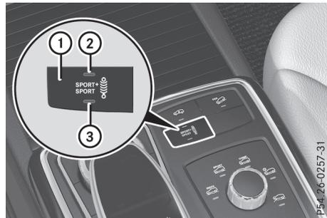
En mode de conduite « Sport », le réglage plus ferme de la suspension permet un contact avec la chaussée encore meilleur. Sélectionnez ce mode pour une conduite énergique, par exemple sur des routes de campagne sinueuses.
