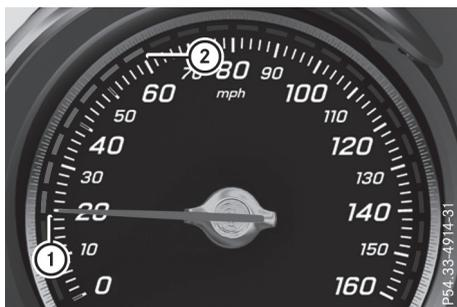
Lorsque le pilote automatique de régulation de distance DISTRONIC détecte un véhicule qui vous précède, les segments du tachymètre compris entre la vitesse de ce véhicule ① et la vitesse mémorisée ② s'allument.
