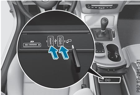
Prises USB dans le cas des véhicules équipés d'un système de navigation (exemple)
