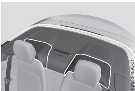
Les arceaux de sécurité se trouvent sous les caches situés derrière les appuie-tête arrière. Les arceaux de sécurité se déclenchent lorsqu'un risque de retournement du véhicule est détecté.
