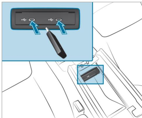
Le kit de raccordement multimédia se trouve dans le bac de rangement sous l'accoudoir et présente 2 prises USB de type C. En fonction de l'équipement du véhicule, des prises USB supplémentaires se trouvent dans le vide-poches de la console centrale avant ou dans le bac de rangement basculant situé à l'arrière.
