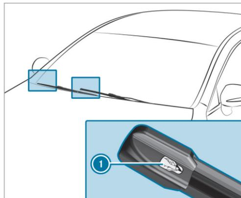
► Retirez le film de protection ① de l'indicateur d'encrassement situé à l'extrémité des balais d'essuie-glace nouvellement montés.
