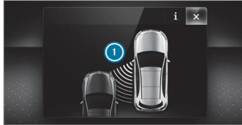
Lorsqu'une intervention de freinage permettant de corriger la trajectoire a lieu, le voyant rouge d'alerte intégré au rétroviseur extérieur clignote et un signal d'alerte retentit. En outre, un affichage ① signalant un risque de collision latérale apparaît sur l'écran multifonction.
