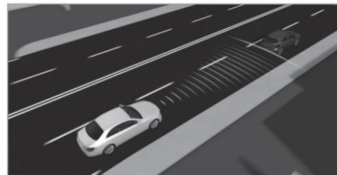
L'assistant de régulation de distance DISTRONIC actif maintient la vitesse réglée en cas de trafic fluide. En cas de véhicules qui précèdent détectés, la distance réglée est maintenue, si nécessaire jusqu'à l'arrêt complet. Le véhicule accélère ou ralentit en fonction de la distance par rapport au véhicule qui précède et de la vitesse réglée. La vitesse, comprise entre 15 mph (20 km/h) et 120 mph (200 km/h) dans le cas des véhicules sans Pack Assistance à la con-
