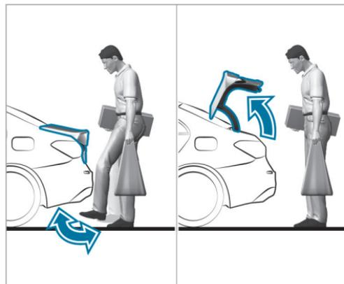
La fonction HANDS-FREE ACCESS vous permet d'ouvrir le couvercle de coffre d'un mouvement du pied sous le pare-chocs.
