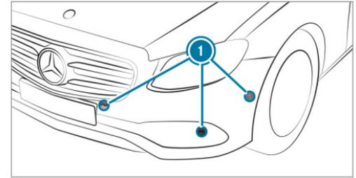
L'assistant de stationnement PARKTRONIC est une aide au stationnement électronique qui fonctionne avec des ultrasons. Il surveille les environs du véhicule à l'aide de plusieurs capteurs ① situés dans le pare-chocs avant et arrière. L'assistant de stationnement PARKTRONIC vous indique de manière optique et sonore la distance qui sépare le véhicule d'un obstacle détecté.
