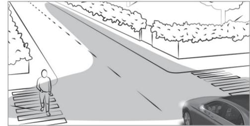
L'éclairage d'intersection augmente considérablement l'angle d'éclairage de la chaussée qu'emprunte le véhicule et permet ainsi de mieux repérer les virages serrés, par exemple. Il peut uniquement être activé lorsque les feux de croisement sont allumés.
