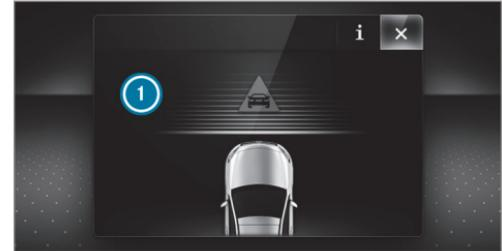
Lorsqu'un freinage autonome ou une assistance au freinage asservie à la situation a été déclenché, l'affichage ① apparaît sur l'écran multifonction, puis disparaît automatiquement après un court instant.
