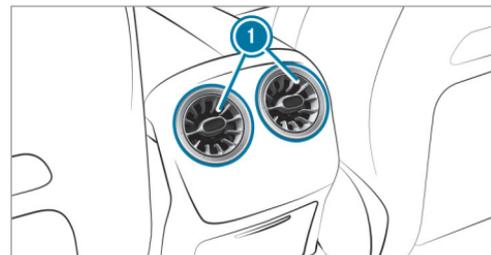
► **Ouverture et fermeture** : saisissez la buse de ventilation ① par la partie centrale et tournez-la vers la gauche (ouverture) ou la droite (fermeture) jusqu'en butée.
