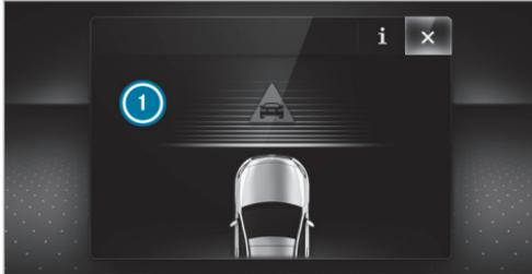
Lorsqu'un freinage autonome ou une assistance au freinage asservie à la situation a été déclenché, l'affichage ⓘ apparaît sur l'écran multi-fonction, puis disparaît automatiquement après un court instant.
