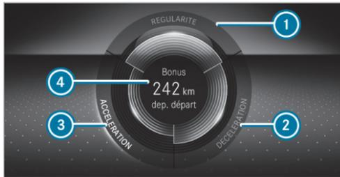
Les inscriptions du segment s'allument en clair, le bord extérieur s'allume et le segment se remplit pour les styles de conduite suivants :
