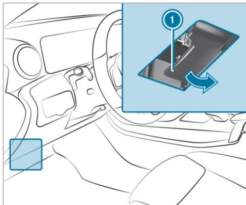
► **Ouverture** : pour déverrouiller le capot moteur, tirez la poignée ①.
