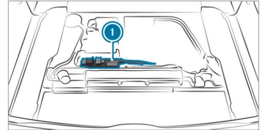
La boîte à fusibles ① se trouve sous le plancher de compartiment de chargement.
