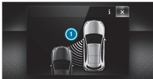
Lorsqu'une intervention de freinage permettant de corriger la trajectoire a lieu, le voyant rouge d'alerte intégré au rétroviseur extérieur clignote et un signal d'alerte retentit. En outre, un affichage ⓘ signalant un risque de collision latérale apparaît sur l'écran multifonction.
