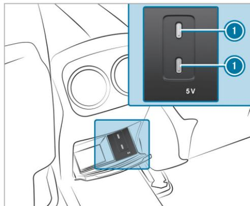
Lorsque le contact est mis, vous pouvez recharger un appareil USB sur les prises USB ① à l'aide d'un câble de charge adapté (téléphone portable, par exemple).
