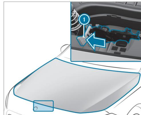
► Poussez la poignée jaune ① du verrou de sécurité du capot avec la main (dos de la main vers le haut) vers la gauche jusqu'en butée. Soulevez le capot moteur jusqu'à ce qu'il se soulève automatiquement sous l'effet du vérin à gaz.
