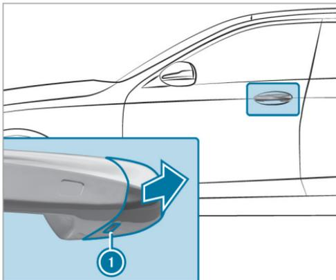
▶ Engagez la clé de secours dans l'orifice ① du capuchon jusqu'en butée.
