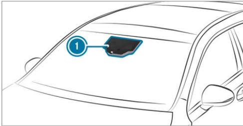
L'assistant de signalisation routière détecte les panneaux à l'aide d'une caméra multifonction ①. Il vous aide en affichant les limites de vitesse et interdictions de dépasser détectées sur le combiné d'instruments et, en option, sur l'affichage tête haute ou sur l'écran central.
