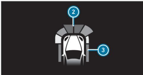
Les obstacles détectés par l'assistant de stationnement PARKTRONIC se trouvant à moins de 3,3 ft (1,0 m) environ à l'avant ② et 2,0 ft (0,6 m) environ sur les côtés ③ peuvent, en option, également apparaître dans l'affichage tête haute.
