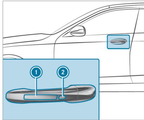
▶ **Déverrouillage du véhicule** : touchez le côté intérieur de la poignée de porte.
