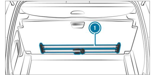
① Barre télescopique avec éléments de fixation et supports
