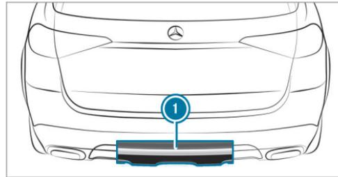
**1** Zone de détection des capteurs
