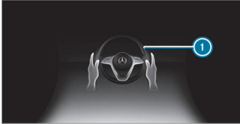
Si le système détecte que le conducteur ne dirige pas lui-même le véhicule ou qu'il lâche le volant pendant une période prolongée, l'affichage ❶ apparaît sur l'écran multifonction. Si le conducteur ne dirige toujours pas activement le véhicule ou ne donne pas de signal de confirmation au système, un signal d'alerte retentit de façon répétée en plus de l'alerte optique.
