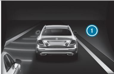
Lorsqu'une intervention de freinage permettant de corriger la trajectoire a lieu, le voyant rouge d'alerte intégré au rétroviseur extérieur clignote et un signal d'alerte retentit. En outre, un affichage ① signalant un risque de collision latérale apparaît sur l'écran multifonction.
