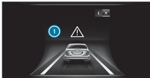
Lorsqu'un freinage autonome ou une assistance au freinage asservie à la situation a été déclenché, l'affichage
