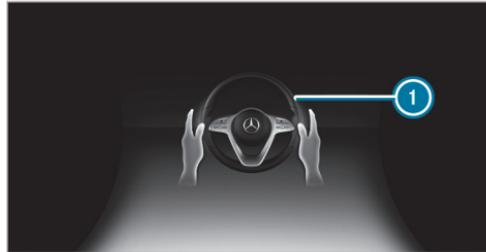
Si le système détecte que le conducteur ne dirige pas lui-même le véhicule ou qu'il lâche le volant pendant une période prolongée, l'affichage **1** apparaît. Si le conducteur ne dirige toujours pas activement le véhicule, un signal d'alerte retentit de façon répétée en plus de l'alerte optique.
