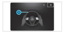
Si le système détecte que le conducteur ne dirige pas lui-même le véhicule ou qu'il lâche le volant pendant une période prolongée, une alerte optique (1) se déclenche. Si le conducteur ne dirige toujours pas activement le véhicule ou ne donne pas de signal de confirmation au système, un signal d'alerte retentit de façon répétée en plus de l'alerte optique.
