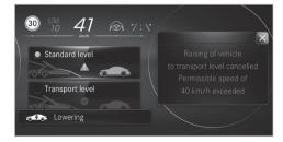
Le véhicule se règle à la hauteur du dernier niveau activé.
