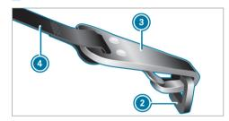
Passez la sangle Top Tether sous l'appuietête entre les 2 tiges de guidage de l'appuie-tête.
