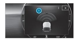
Lorsqu'un freinage autonome ou une assistance au freinage asservie à la situation a été déclenché, la fenêtre contextuelle (1) apparaît sur l'écran conducteur, puis disparaît automatiquement après un court instant.
