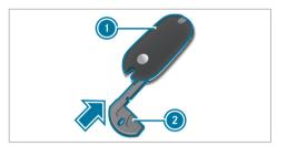
Poussez la clé de secours ② dans le sens de la flèche dans l'orifice de la clé jusqu'à ce que le cache ⑥ s'ouvre. Ce faisant, ne bloquez pas le cache ⑥.
