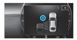
Lorsau'une intervention de freinage permettant de corriger la trajectoire a lieu, le voyant rouge d'alerte intégré au rétroviseur extérieur clignote et un signal d'alerte retentit. En outre, un affichage 1 signalant un risque de collision latérale apparaît sur l'écran conducteur.
