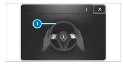
Si le système détecte que le conducteur ne dirige pas lui-même le véhicule ou qu'il lâche le volant pendant une période prolongée, une alerte optique se déclenche d'abord. L'affichage apparaît sur l'écran conducteur. Si le conducteur ne dirige toujours pas activement le véhicule ou ne donne pas de signal de confirmation au système, un signal d'alerte retentit de façon répétée en plus de l'alerte optique.
