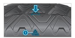
Six repères  $\bigcirc$  indiquent les emplacements auxquels les indicateurs d'usure (flèche), qui se présentent sous la forme de barrettes, sont intégrés dans les sculptures du pneu. Ils sont visibles dès que la profondeur des sculptures de pneu atteint environ  $\mathcal{V}_{16}$  in (1,6 mm).
