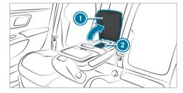
Recharge sans fil à l'arrière sur les véhicules équipés d'une tablette arrière MBUX
