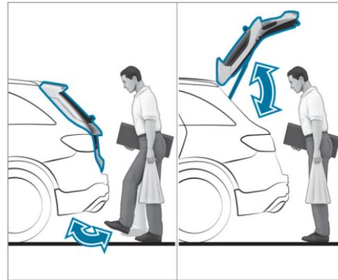
La fonction HANDS-FREE ACCESS vous permet d'ouvrir, de fermer ou de stopper le hayon d'un mouvement du pied sous le pare-chocs.
