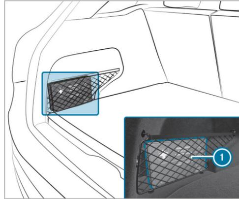
La trousse de secours ❶ se trouve à gauche dans le compartiment de chargement, dans le filet de rangement.
