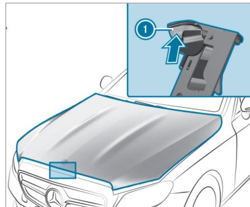
► Poussez la poignée ① du verrou de sécurité du capot moteur vers le haut et soulevez le capot moteur jusqu'à ce qu'il s'ouvre automatiquement.
