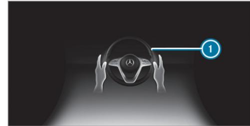
Si le système détecte que le conducteur ne dirige pas lui-même le véhicule ou qu'il lâche le volant pendant une période prolongée, l'affichage ① apparaît sur l'écran multifonction. Si le conducteur ne dirige toujours pas activement le véhicule ou ne donne pas de signal de confirma-
