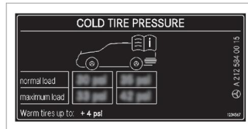
Si la pression de pneu est précédée de l'indication d'une ou de plusieurs dimensions de pneus, cela signifie que la pression indiquée est uniquement valable pour ces tailles de pneus et l'état de chargement respectif.
