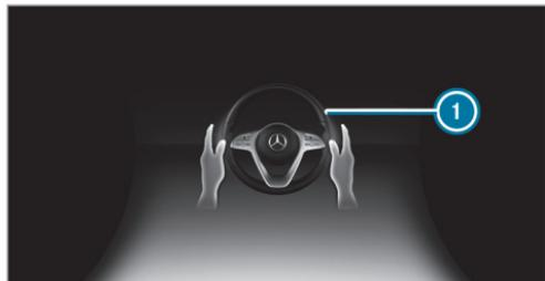
Si le système détecte que le conducteur ne dirige pas lui-même le véhicule ou qu'il lâche le volant pendant une période prolongée, l'affichage ❶ apparaît. Si le conducteur ne dirige toujours pas activement le véhicule, un signal d'alerte retentit de façon répétée en plus de l'alerte optique.
