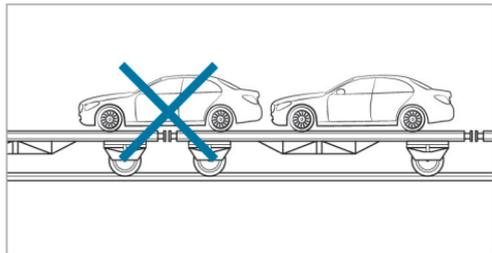
▶ Veillez à ce que l'essieu avant et l'essieu arrière soient immobilisés sur le même véhicule de transport.
