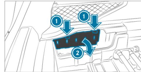
Poussez les agrafes de retenue ① du cache vers le bas pour les décrocher et basculez le cache dans le sens de la flèche ②.
