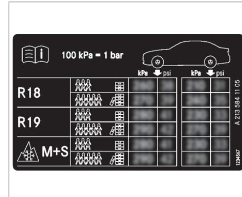
Certains tableaux de pression des pneus mentionnent uniquement le diamètre des jantes (R18, par exemple) à la place des dimensions de pneus complètes. Le diamètre des jantes est indiqué dans les dimensions des pneus et figure sur le flanc des pneus (→ page 366).
