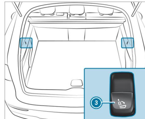
Si nécessaire, le siège avant concerné s'avance quelque peu pour empêcher toute collision lorsque le dossier arrière est basculé.
