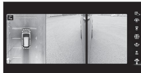
Lorsque la liaison électrique entre le véhicule et la remorque est établie, l'affichage passe à une vue des caméras latérales.
