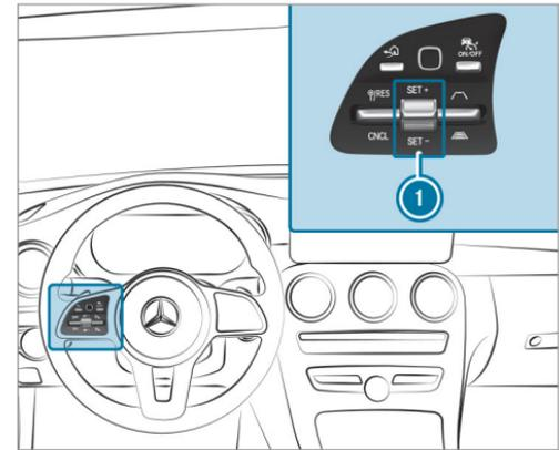
▶ **Commande de l'assistant de régulation de distance DISTRONIC actif** : actionnez les touches de l'unité de commande sur le volant vers le haut ou vers le bas dans la position souhaitée.
