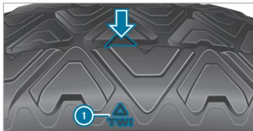
Six repères ① indiquent les emplacements auxquels les indicateurs d'usure (flèche), qui se présentent sous la forme de barrettes, sont intégrés dans les sculptures du pneu. Ils sont visibles dès que la profondeur des sculptures de pneu atteint environ  $\frac{1}{16}$  in (1,6 mm).
