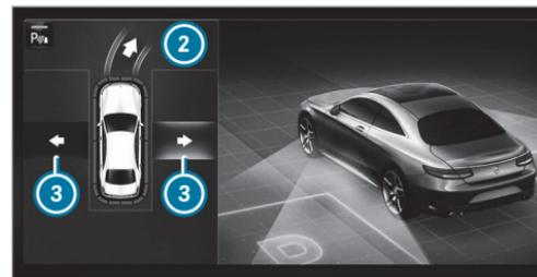
▶ Si le véhicule a été garé perpendiculairement au sens de la marche: sélectionnez dans la zone **2** la direction que vous devez prendre pour sortir de la place de stationnement **3** **Côté G** ou **Côté D**.
