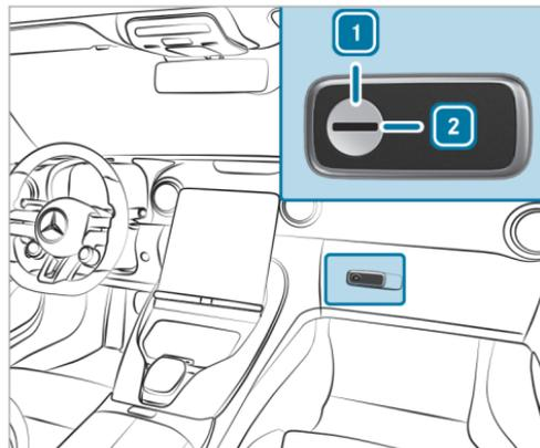
► Tournez la clé de secours d'un quart de tour vers la droite ② (verrouillage) ou vers la gauche ① (déverrouillage).
