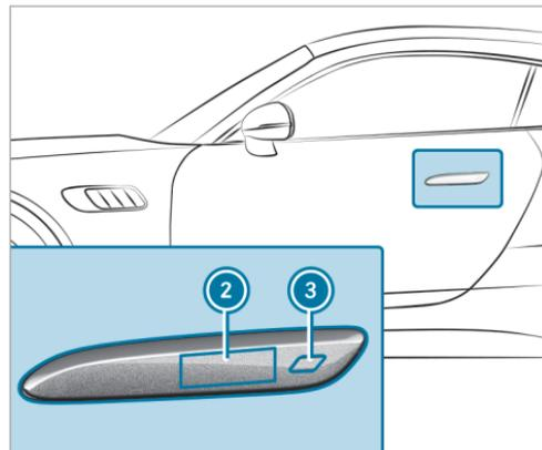
▶ **Si le véhicule est déverrouillé :** touchez le capteur ② ou ③ pour sortir la poignée de porte.
