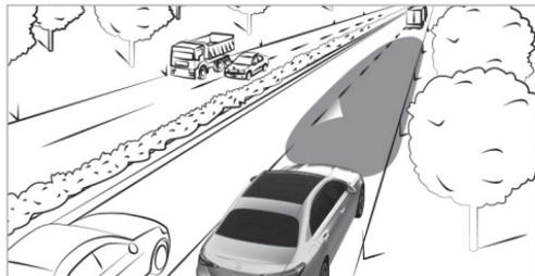
A une vitesse égale ou supérieure à 19 mph (30 km/h), un triangle est projeté sur la chaussée pour indiquer une correction de trajectoire et afficher sa direction dans les cas suivants:
