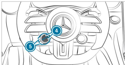
▶ Appuyez sur le contacteur d'écran supérieur ou inférieur ④ à plusieurs reprises jusqu'à ce que le symbole
