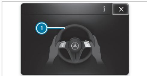
Si le système détecte que le conducteur ne dirige pas lui-même le véhicule ou qu'il lâche le volant pendant une période prolongée, une alerte optique se déclenche d'abord. L'affichage ① apparaît sur l'écran conducteur. Si le conducteur ne dirige toujours pas activement le véhicule ou ne donne pas de signal de confirmation au système, un signal d'alerte retentit de façon répétée en plus de l'alerte optique.
