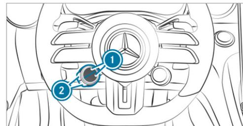
Les touches AMG du volant se composent d'un élément de commande supplémentaire à 2 touches.
