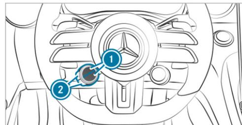
► Appuyez sur le contacteur d'écran supérieur ou inférieur ① à plusieurs reprises jusqu'à ce que le symbole
