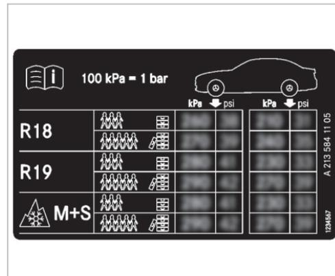
Certains tableaux de pression des pneus mentionnent uniquement le diamètre des jantes (R18, par exemple) à la place des dimensions de pneus complètes. Le diamètre des jantes est indiqué dans les dimensions des pneus et figure sur le flanc des pneus (→ page 390).
