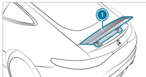
L'aileron arrière ① améliore la stabilité de marche du véhicule et adapte ainsi l'aérodynamisme du véhicule aux conditions de marche.
