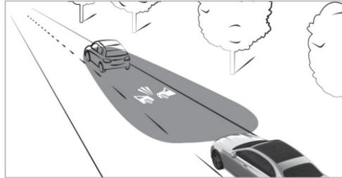
A une vitesse égale ou supérieure à 19 mph (30 km/h), si vous ne respectez pas la distance de sécurité, un symbole d'alerte de collision est projeté sur la chaussée.
