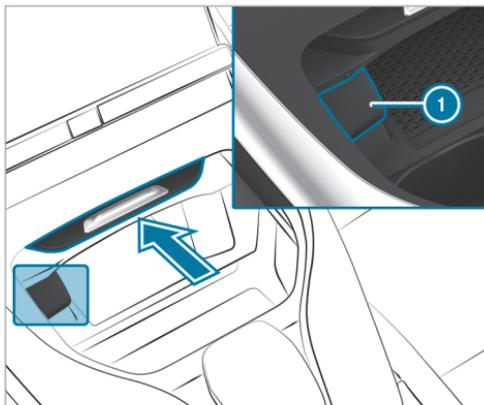
Prise 12 V dans le vide-poches situé dans la console centrale à l'avant (exemple)
