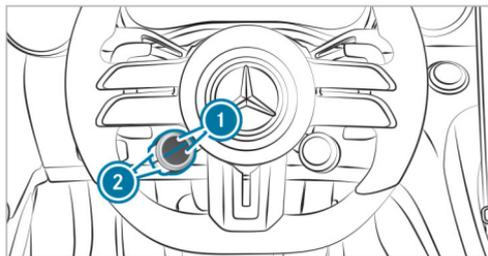
▶ Appuyez sur le contacteur d'écran supérieur ou inférieur **1** à plusieurs reprises jusqu'à ce que le symbole
